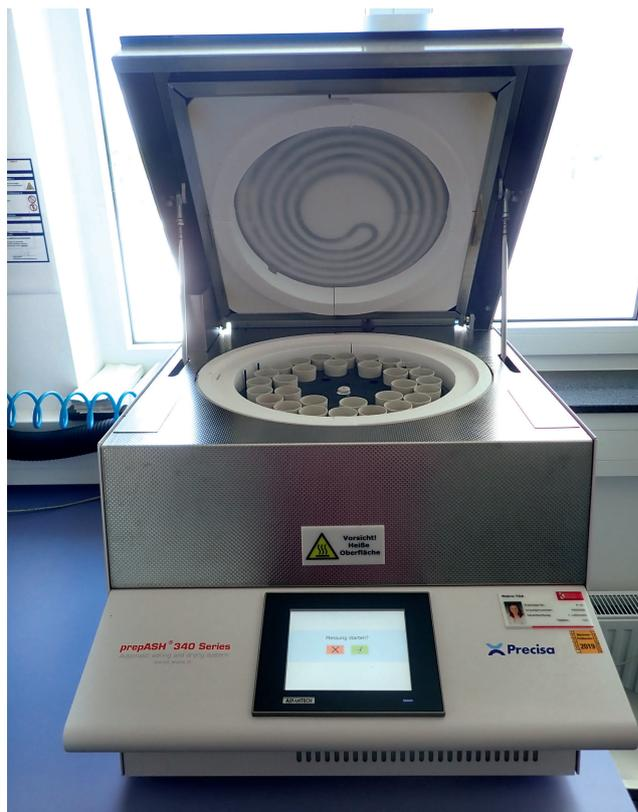
Das automatisierte thermogravimetrische Analysesystem prepASH kombiniert Messungen und Auswertungen
